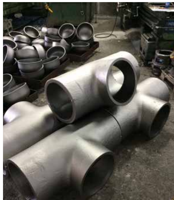
Sonderteile für das Projekt: T-Stücke mit verlängerten Maßen in unbearbeitetem Zustand
